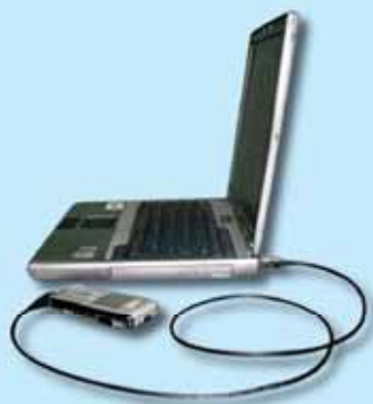
▲ ภาพแสดงการใช้โทรศัพท์มือถือและ Notebook เพื่อเชื่อมต่อสัญญาณอินเทอร์เน็ต ในระบบ GPRS
